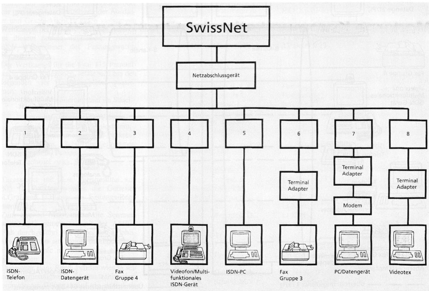
Ein Bus, der bis zu acht Steckdosen aufnimmt. Beispiel für einen Basis-Anschluss beim Teilnehmer. Ein Bus, der bis 150 Meter lang sein kann, verbindet die acht Swissnet-Steckdosen. Er ist an das Netzabschlussgerät angeschlossen.
