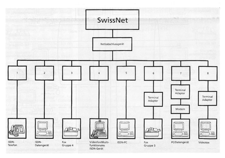
Ein Bus, der bis zu acht Steckdosen aufnimmt. Beispiel für einen Basis-Anschluss beim Teilnehmer. Ein Bus, der bist 150 Meter lang sein kann, verbindet die acht Swissnet-Steckdosen. Er ist an das Netzabschlussgerät angeschlossen.
