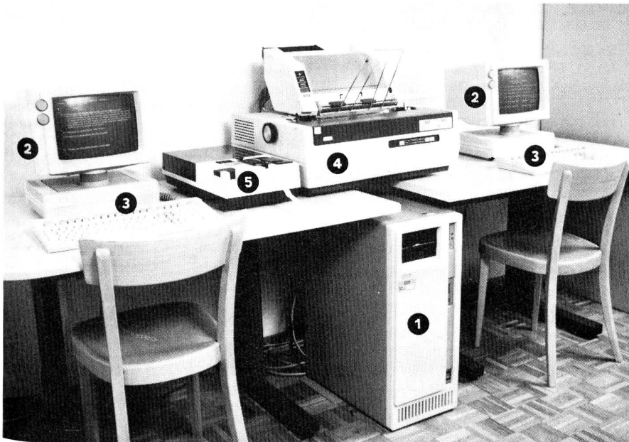
Das TVS-86 hat zwei Arbeitsplätze und besteht aus Zentraleinheit (1), Bildschirm (2), Tastatur (3), Matrixdrucker (4) und Lochstreifenstanzer / -leser (5). – Le TVS-86 a deux places de travail et se compose de: Unité centrale (1), écran (2), clavier (3), imprimante à aiguilles (4) et perforateur/lecteur de bandes (5). (Foto: Ta BAUEM)
