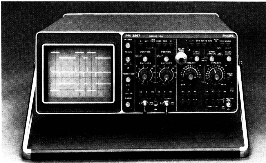
Philips-PM-3267-100-MHz-Oszilloskop der Economy-Klasse
