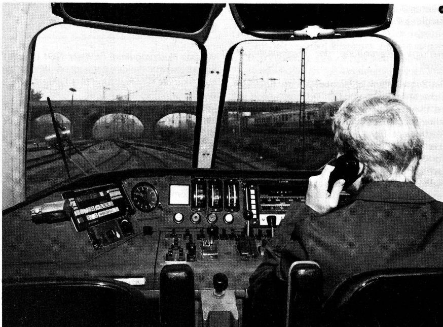
AEG-Telefunken hat über 8000 Triebfahrzeuge und 13000 Streckenkilometer der Deutschen Bundesbahn mit einem Zugbahnfunk-System im 460 MHz-Bereich ausgerüstet. Das Bild zeigt einen Führerstand eines Triebfahrzeuges mit dem Zugbahnfunkgerät (links im Bild).
