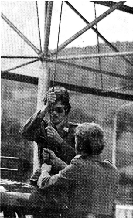
Zum Bereitstellen der Fahrzeuge nach der Materialkontrolle gehört auch die Montage der Fahrzeugantenne SE-222
