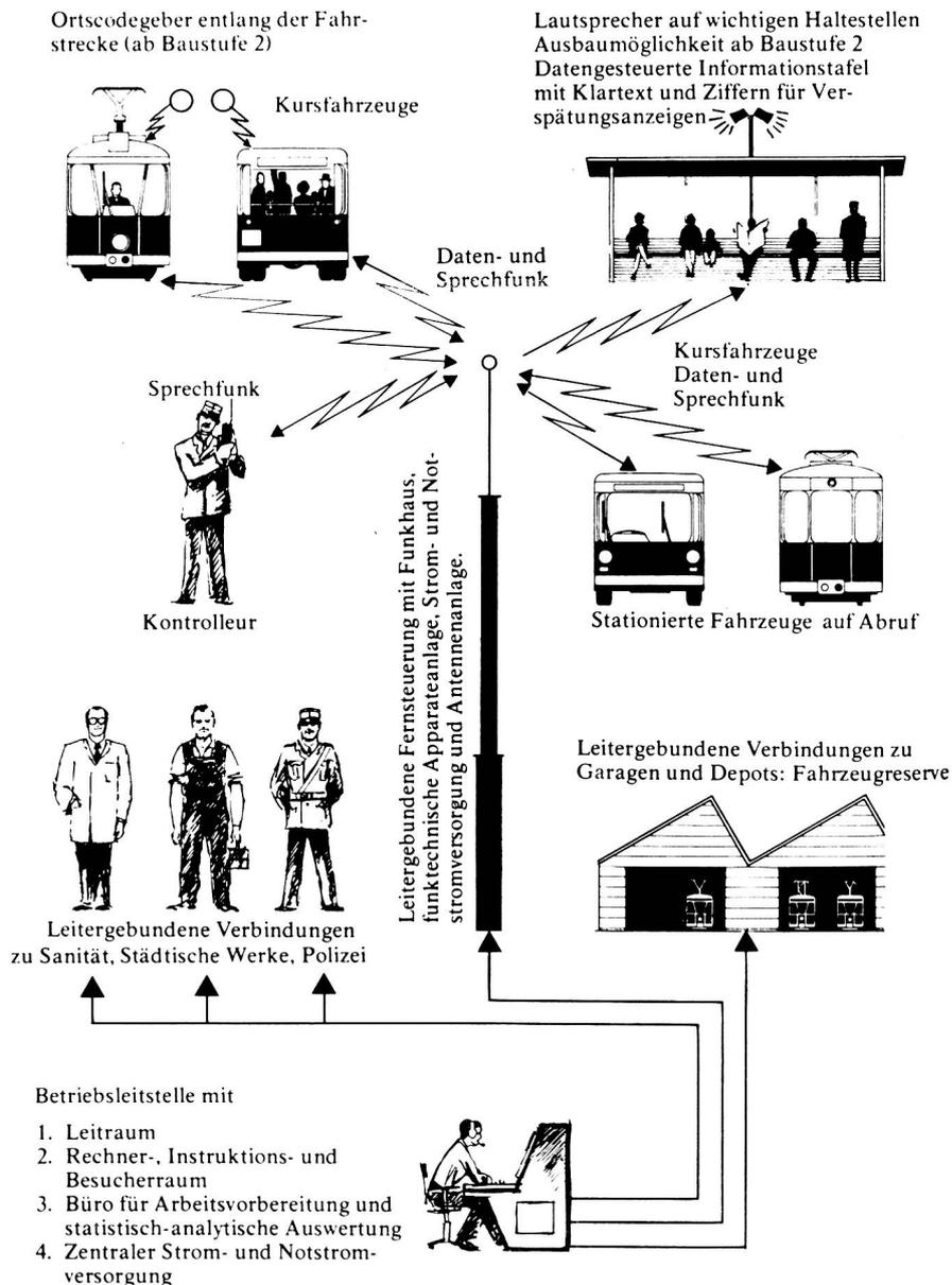
Bild 1: Die Verbindungen im datengesteuerten Funkleitsystem der VBZ
