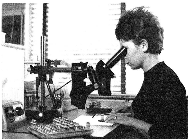
Laufende Kontrolle von Kaltkathodenröhren mit dem Mikroskop.
