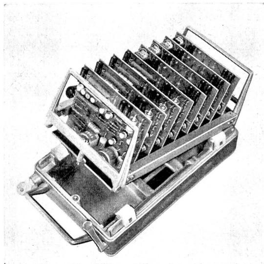
Fig. 10. Baugruppe, gemischt bestückt mit Ein-/Aus- und Messkanälen.
