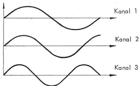
Fig. 5. Zuordnung von verschiedenen Frequenzen als Informationsträger im Frequenzmultiplex-System.
