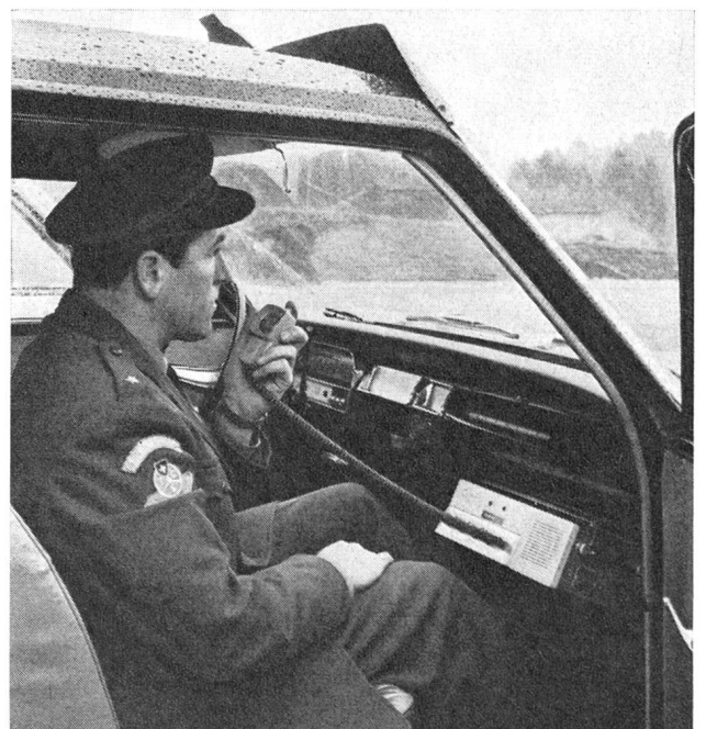
Abb. 9. Bei den in den Fahrzeugen eingebauten Funkanlagen handelt es sich um Geräte der englischen Firma PYE. Die Geräte lassen sich an einem Drehknopf auf 3 Kanäle umschalten. Notfalls sind sie mit wenigen Handgriffen auswechselbar.
