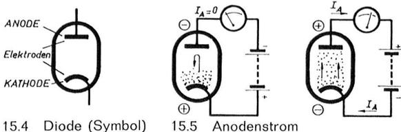
Dieser Anodenstrom fliesst zur Stromquelle, die auch immer neue Elektronen zur Kathode bewegt. Bei genügender Heizung
