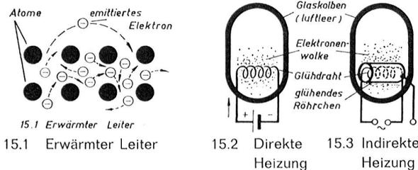
Durch Einbau einer weiteren Elektrode entsteht eine Zweipolröhre: die Diode (15.4). Die Heizung wird im Symbol meist nicht mehr gezeichnet. Man nennt die Elektroden Kathode und Anode (s. 5.5). Verbinden wir die Röhrenanschlüsse mit einer Batterie, können bei negativer Anode keine Elektronen (—) zur Anode gelangen, da sie abgestossen werden. Eine positive Anode hingegen zieht die Elektronen an — es findet ein Elektronenfluss durch die Röhre statt! (15.5).
