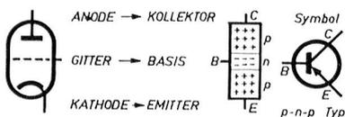
273 18.1 Vergleich: Röhre—Transistor
