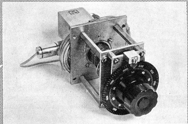
Die Antennenfilter haben genauen Gleichlauf und werden durch einen Drehknopf mit frequenzgeeichter Skala eingestellt
