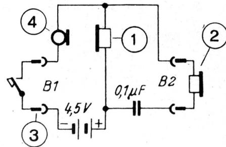
Fig. 2. Montage de l'oscillateur microphonique.
