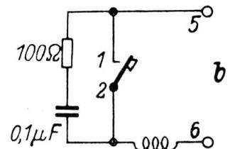
Fig. 5. Installation anti-parasites composée d'une résistance, d'un condensateur et d'une self HF.
