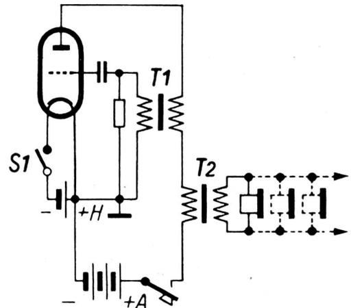
Fig. 11. Couplage du casque d'écoute au transformateur T2, exempt de courant continu.
