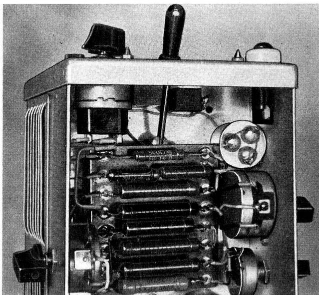
Fig. 6. Vue des connexions du manipulateur électronique (voir schéma 4). Au centre, on voit le levier du manipulateur pour les traits et les points.
