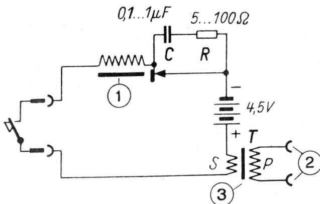
Fig. 1. Montage d'un oscillateur magnétique avec sortie pour casque d'écoute.
