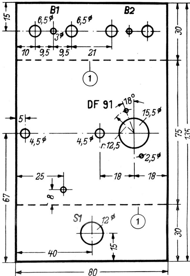
Fig. 9. Dimensions du boîtier de l'oscillateur pour lampes à chauffage par batterie. 1 ligne d'arête.
