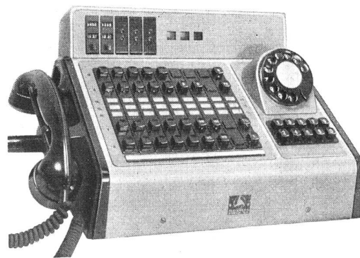
Neue Albis-Vermittlungsstation mit Blocktasten
