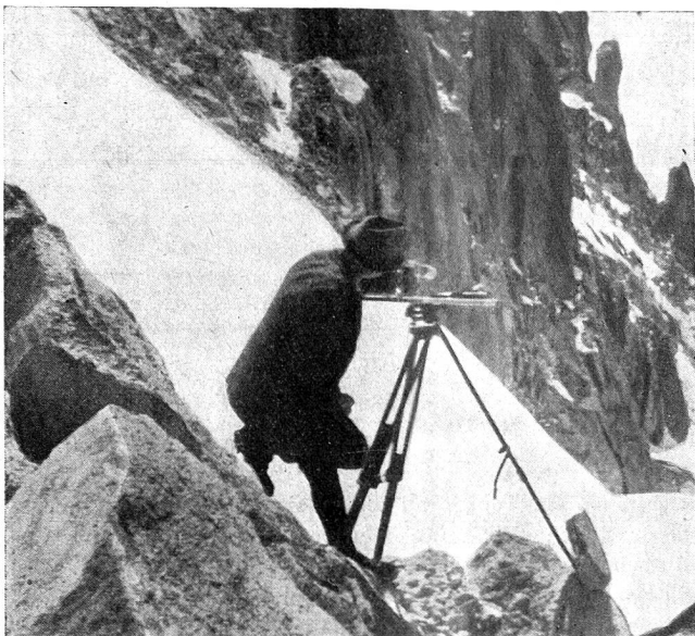
Im Gelände aufgestellter Meßtisch mit Topograph. Levé dans le terrain.
