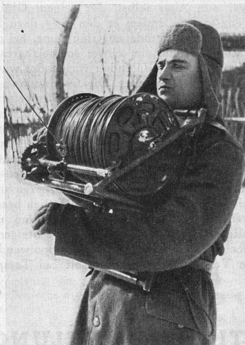
Bei einer deutschen Nachrichtenkompanie an der Ostfront Feldkabel wird verlegt (Beachte die Spilleinrichtung am Tragreff)
