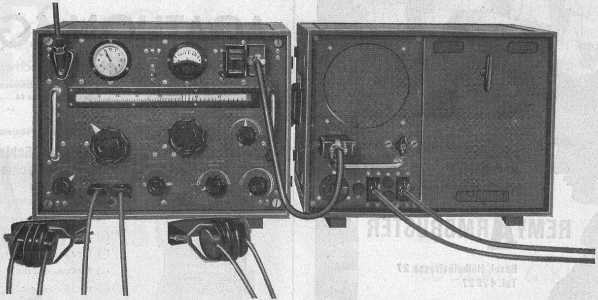
Der moderne **Allwellenempfänger** in feldmäßiger Ausführung mit Zubehörkasten und eingebautem Lautsprecher
