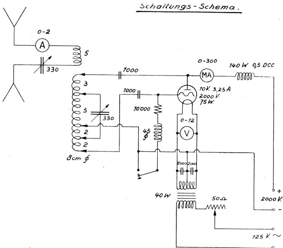
1. *Der Primär-Heizstromkreis.* Er umfasst die beiden Anschlussbüchsen für den Anschluss an das Ortsnetz, die Primärwicklung des Heiztransformators und den Heizspannungs-Regulierwiderstand.
