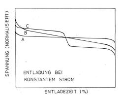
Fig. 7 Entladekurven bei konstantem Strom.
