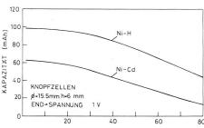
Fig. 15 Kapazität als Funktion des Entladestroms.
