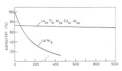
Fig. 16 Kapazität als Funktion der Zyklenzahl.
