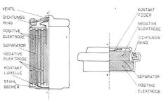
Fig. 14 Aufbau von Nickel-Wasserstoff-Akkumulatoren.
