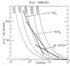
Fig. 11 Abhängigkeit der Zyklenzahl von der Entladetiefe.
