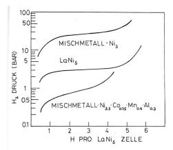
Fig. 12 Gleichgewichts- Wasserstoffdruck für Wasserstoff-Speicherelektroden.
