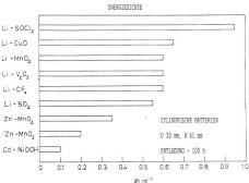
Fig. 10 Energiedichte von zylindrischen Batterien.
