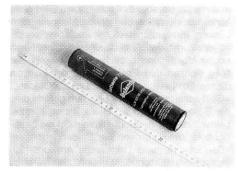
Fig. 19 5,7-V-Flachzellen-Batterie.
