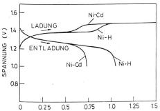
Fig. 13 Lade- und Entladekurven von Nickel-Kadmium und Nickel-Wasserstoff.
