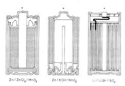
Fig. 9 Aufbau von zylindrischen Batterien.
