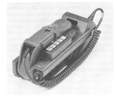
Die Bedieneinheit besteht aus dem Gehäuseoberteil (Tastatur, Anzeige und Ruforgan) sowie dem Gehäuseunterteil (Elektronik und NEMP-Schutz). Das Gehäuse ist feldtauglich, verfügt über einen von aussen zugänglichen Batteriekanal (vier «Mignon»-Batterien) und ist auf der Rückseite mit einer Kurzbedienungsanleitung versehen.
