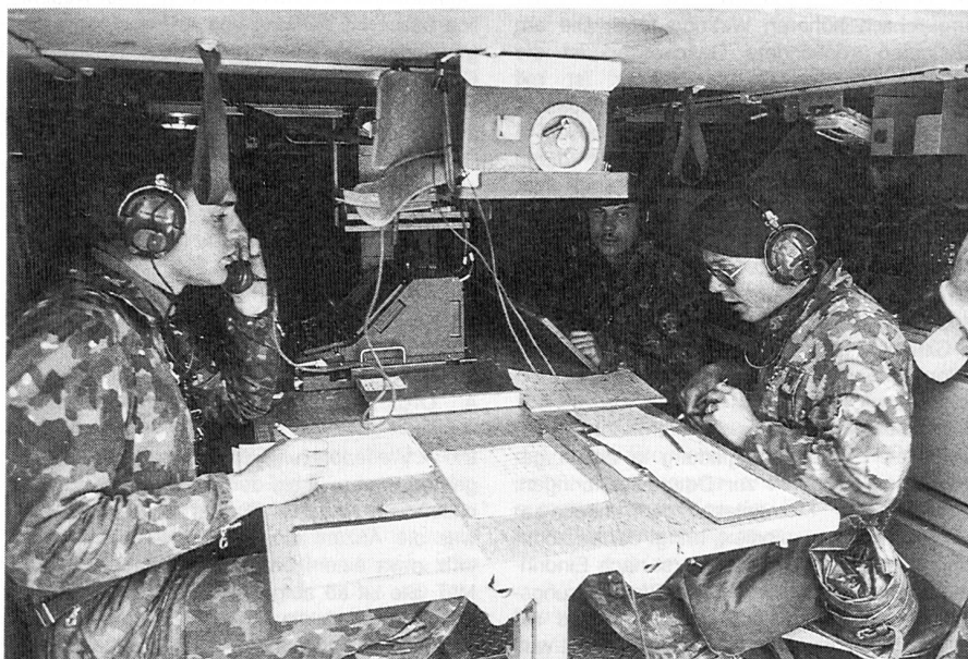
Mit Hilfe des FARGO-Rechners werden auf der Batterie-Feuerleitstelle die Schiessselemente berechnet.
