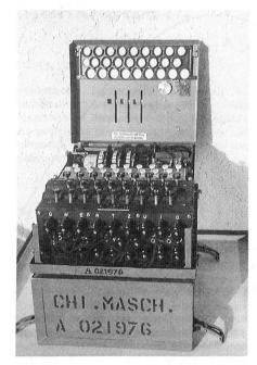
ENIGMA – Deckel hochgeklappt, Gerät über die Abdeckung gestellt. Steckerfeld, Tastatur, 3 Chiffrierwalzen mit «Umkehrwalze» links neben diesen gut sichtbar. (Foto W. Mache)
