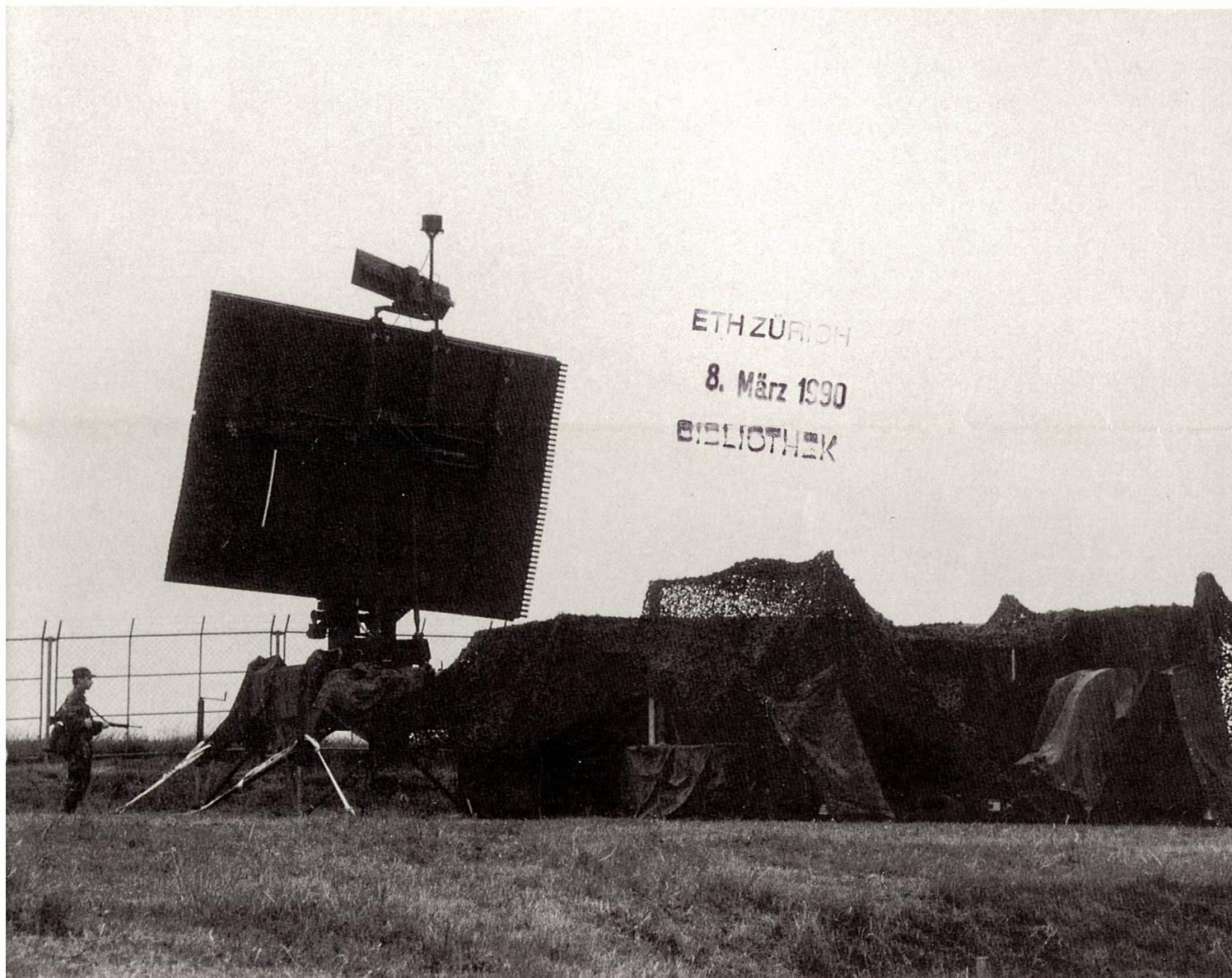
Antenne im Bodenbetrieb, Radar-Shelter und Hilfspalett getarnt.
