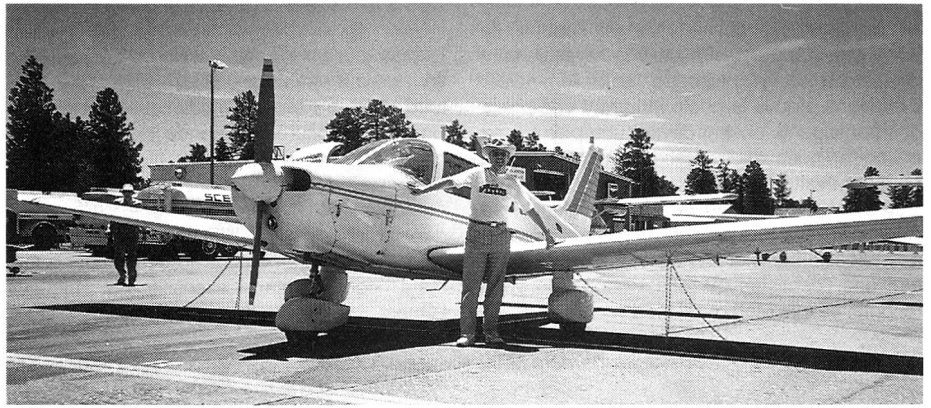
Le vent est tel que l'on est obligé d'amarrer les avions par des chaînes, sous les ailes.
