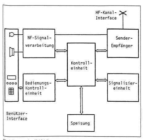
Blockdiagramm einer Mobilstation
