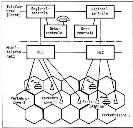
Generelle Netzstruktur des NMT
