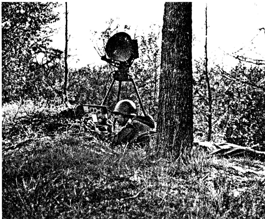
Le radar de surveillance du champ de bataille, équipé d'un analyseur Doppler qui permet l'identification des véhicules observés.
