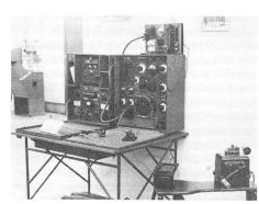
Tragbare schwere Funkstation TS 25: links Empfänger E 25 (Tfk Spez 7 Bs), Mitte Sender Tfk AR 245, rechts Handdrehgenerator HDG 1.
