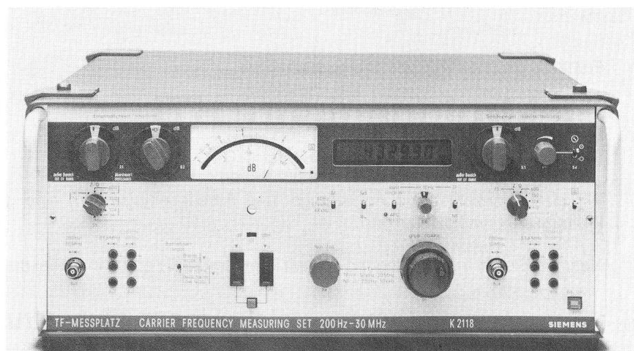
Der neue TF-Messplatz K 2118 von Siemens kann sowohl breitbandig als auch selektiv im Bereich von 200 Hz bis 30 MHz messen. Der Messkombi entspricht in seiner Leistungsfähigkeit den üblichen Standard-Einzelgeräten, übertrifft sie in mancher Hinsicht sogar.
