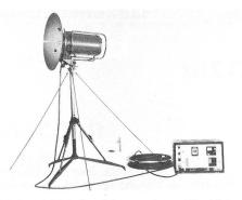
Wird auf Digitalbetrieb umgebaut: Die Kleinrichtstrahlstation R-902 TDM Bild: BAUEM
