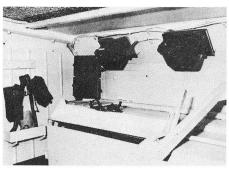
Abbildung 3 und 4 Sender-/Empfänger-Kombination von drei Sätzen (Abbildung 3) im Schützenpanzer an der Frontseite. Die Bedienungseinheiten werden dabei nicht ausgebaut, sondern zwei zusätzliche Bedienungseinheiten mit zugehörenden Niederfrequenz-Anschlussboxen (Abbildung 4) an der linken hinteren Seite des Schützenpanzers montiert. Über die beiden Bedienungseinheiten können alle drei Funksätze gesteuert und überwacht werden.
