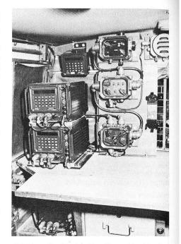
Abbildung 5 Sender-/Empfänger-Kombination bestehend aus drei Sätzen im «Pinzgauer». Zwei Sender-/Empfänger werden direkt bedient. Die dritte Sender-Empfänger-Kombination befindet sich links unterhalb der Fischplatte. Das zugehörige Display befindet sich oberhalb der beiden Sender-/Empfänger. In der rechten Reihe davon, von oben nach unten, das Durchschaltegerät (MA-4122) und die Niederfrequenz-Bedienboxen für die Bordsprechanlage.
