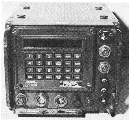
Abbildung 1 Sender-/Empfänger-Kombination mit Tastatur für Eingabe, Displayzeile, Anschluss- und Bedienungselementen
