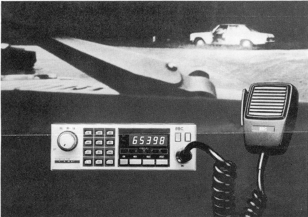
Seit kurzem ist das 900-MHz-Frequenzband für den Jedermannfunk (Personal Radio) freigegeben. Auf 40 Kanälen und mit 5 Watt Sendeleistung können Sie rufen, warnen, Kontakt aufnehmen. Das Gerät dazu heisst Veriphon® 900 «Comet». Es kommt von BBC, ist technologische Spitze und arbeitet mit Synthesizer und Mikroprozessoren. Es ist ein richtiger Funkcomputer mit Selektivruf, Generalruf, automatischer Kanalwahl, Rufnummernspeicher, Fernsteuerung,
