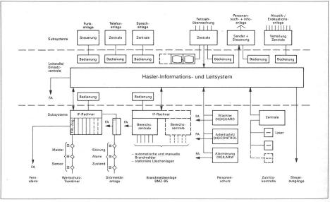
Abb. 1 Schematischer Aufbau des Alarmmanagement-Systems
