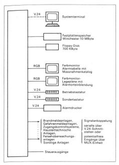
Abb. 2 Alarmmanagement-System mit Bedienpult, Zentralrechner, Farbmonitoren, Tastatur und Druckern
