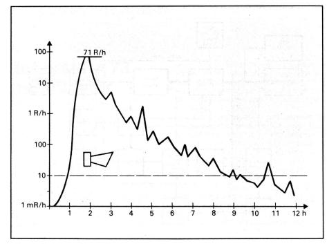
Beispiel eines Verstrahlungsablaufes über zwölf Stunden mit Alarmschwelle bei zehn Milliröntgen
