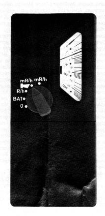
pulse zum Impulsformer. Nach der Formung werden sie im Stromschalter aufbereitet und dem logarithmischen Integrator zugeführt. Das entstehende Gleichspannungssignal wird durch ein über drei Dekaden geeichtes Galvanometer angezeigt.
