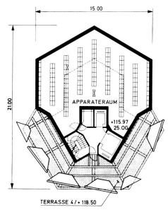
Grundriss + 116 m (Apparateraum und Stahlterrasse mit Richtstrahlantennen).
