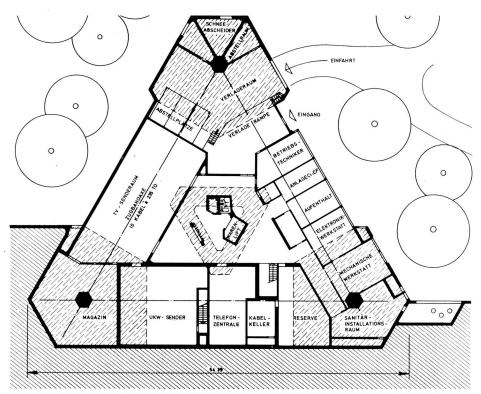
Grundriss Sockelgeschoss – 1 (gestrichelt-schraffiert = Fundamentkörper).
