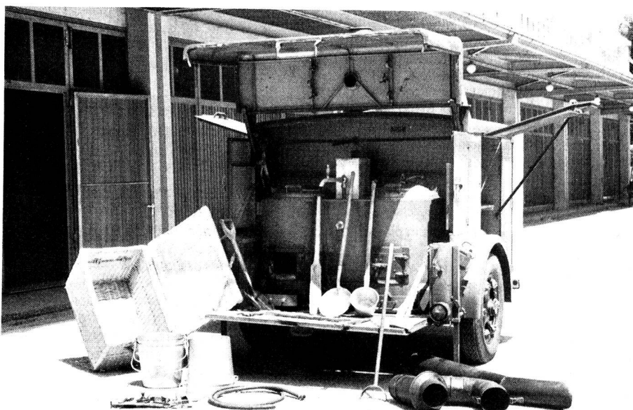
Der Küchenanhänger Modell 42. Er wiegt 1250 Kilo, erträgt eine Nutzlast von 1100 Kilo und misst – fahrbereit – 4 Meter in der Länge, 2,10 Meter in der Höhe und 2,30 Meter in der Breite.
