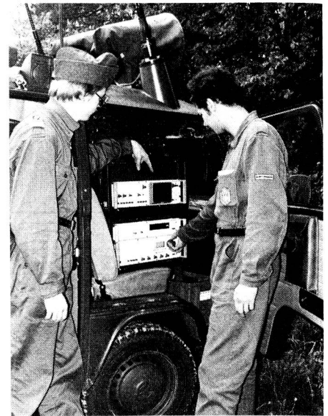
Überwachungsempfänger (im oberen Teil der Panoramazusatz)
