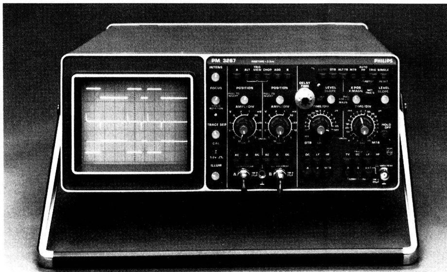
Philips-PM-3267-100-MHz-Oszilloskop der Economy-Klasse
