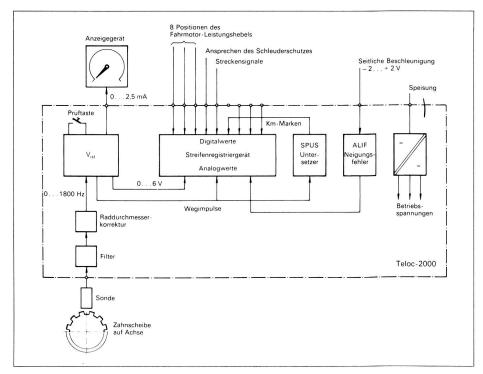
Prinzipschema des Teloc-2000 für die neuen Hochgeschwindigkeitszüge der britischen Bahnen.
