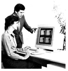
Dank der neuen Technik (Plasma-Leuchtplatte und Funktionen im Mikrocode) kann das neue IBM-Bildschirmterminal 3290 in Unterbildschirme aufgeteilt werden, gleicher oder unterschiedlicher Grösse. Diese Aufteilung gestattet jedem Unterbildschirm eine Anwendung zuzuordnen, was vielfältige Kombinationsmöglichkeiten erlaubt.
