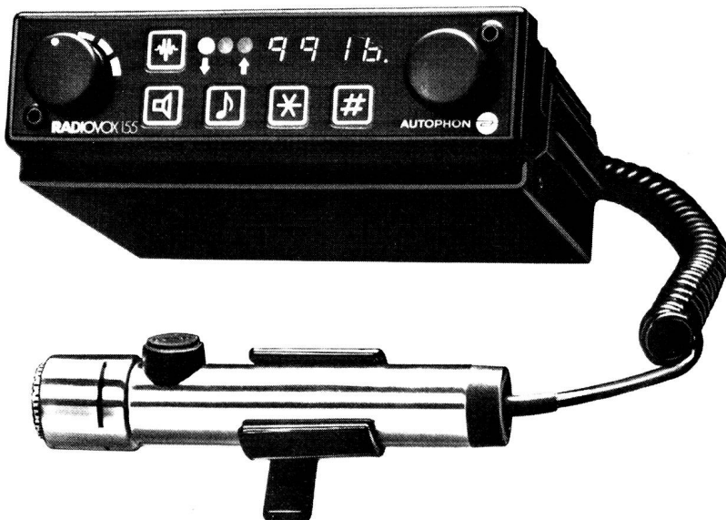
Das neue Sprechfunkgerät Radiovox 155 ist für den Nutzfahrzeugbetrieb gedacht und lässt sich in ein Autoradiofach einbauen.
