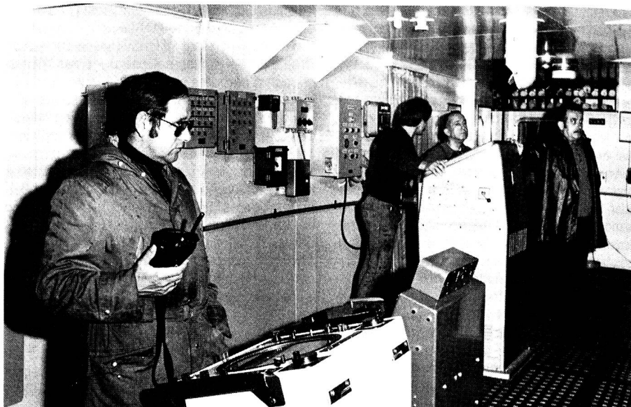
Der Lotse an Bord des Öltankers hat Kontakt mit dem Radarlotsen in der Zentrale Wilhelmshaven. Von dort aus unterstützt man ihn durch Informationen, welche mit dem Küstenradarsystem entlang des Jadefahrwassers gewonnen werden. So können die Tanker sicher bei jedem Wetter auf der nur 300 Meter breiten Tiefwasserrinne in den Hafen dirigiert werden.
