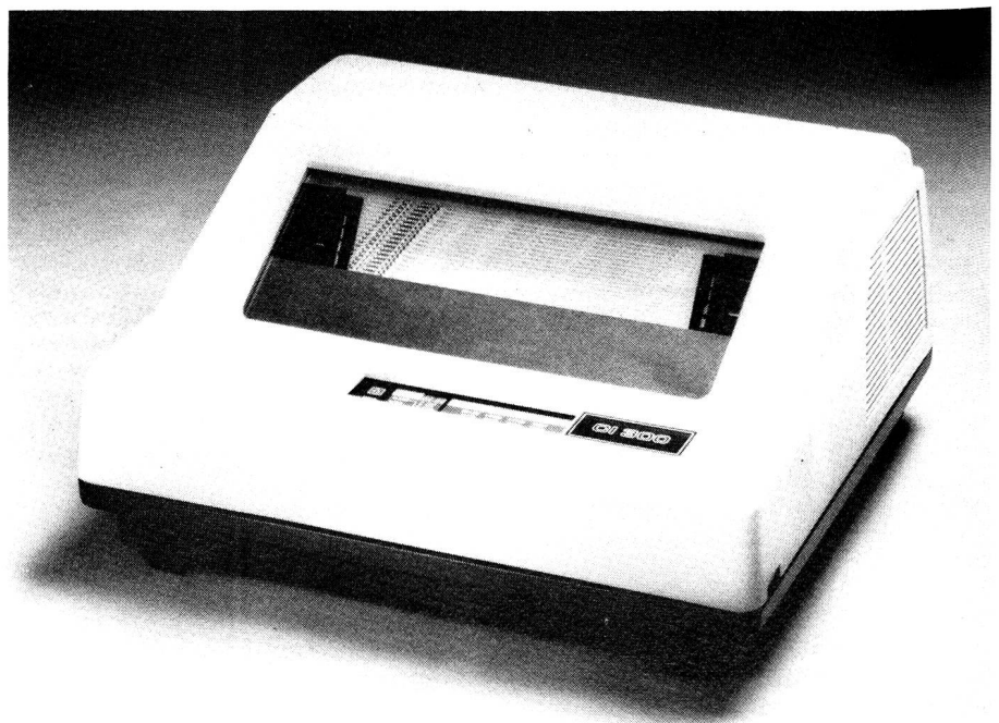
Der japanische Zeilendrucker Itoh 300 mit einer Druckleistung von 300 Zeilen/Min. eignet sich für Schönschreib- und Grafikanwendungen.
