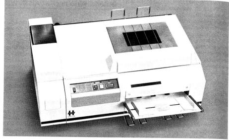
Das Fax-Chiffriersystem HC-440 setzt sich aus dem Fernkopierer- HF 2060 und dem Chiffriergerät (links aussen) zusammen. CRYPTOFAX
