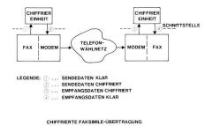
Prinzipieller Aufbau eines digital-chiffrierten Fax-Systems.
