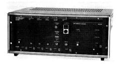
Der Messgenerator PM 5538 von Philips eignet sich für die Prüfung von Videotextdecodern und Fernsehempfängern.
