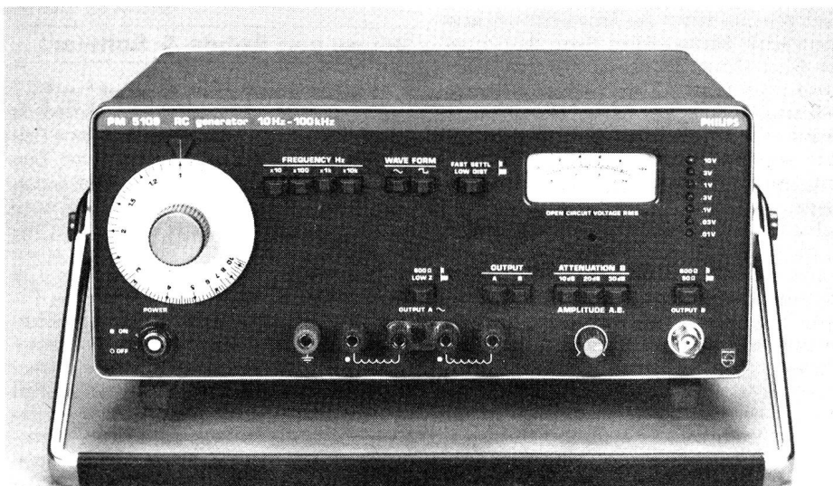
Der neue NF-Generator PM 5109 von Philips deckt den Frequenzbereich von 10 Hz bis 100 kHz ab und ist mit symmetrischem Ausgang erhältlich.
