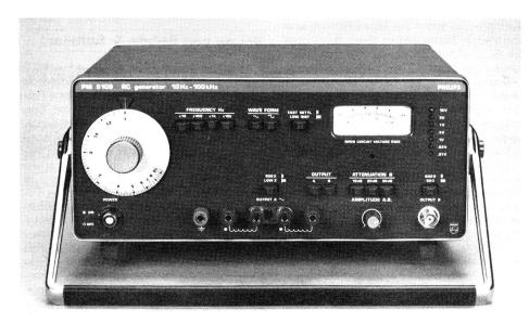
Der neue NF-Generator PM 5109 von Philips deckt den Frequenzbereich von 10 Hz bis 100 kHz ab und ist mit symmetrischem Ausgang erhältlich.
