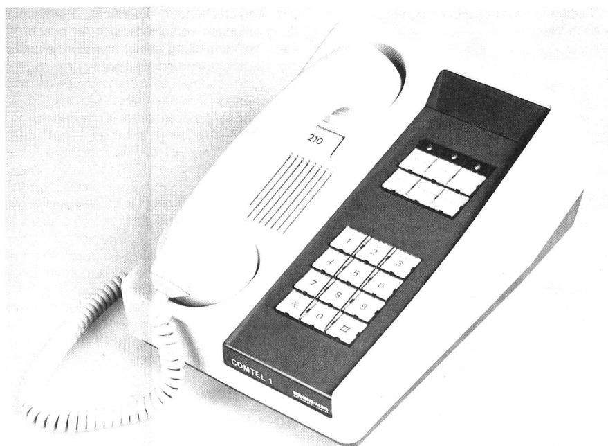
Bild 2: Komfort-Telefonapparat mit Tonruf für mehrere Direktleitungen, angeschlossen über zwei Drähte an moderne elektronische Haustelefonzentrale.
