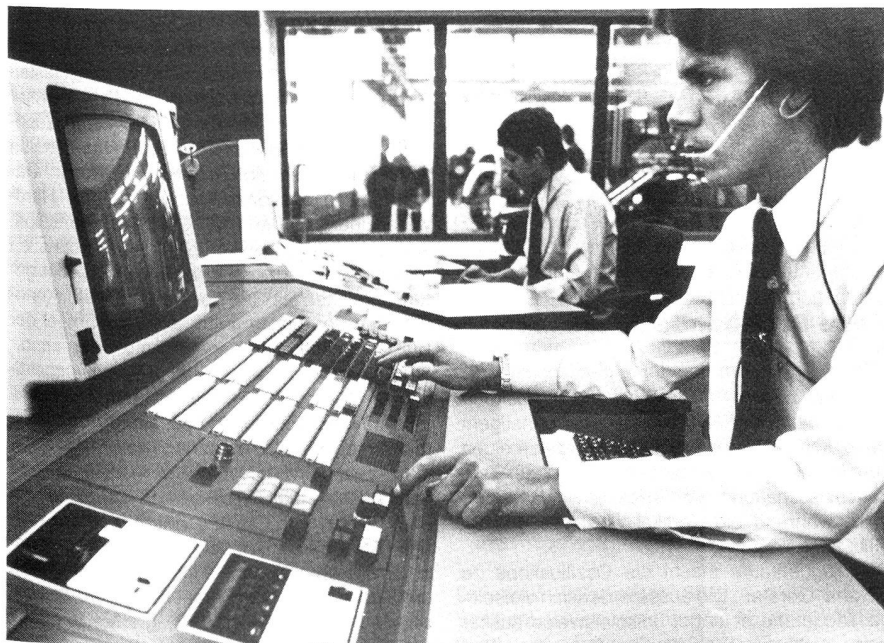
Der neue Einsatzleitrechner ELR 2100 eignet sich dank modularer Bauweise für Feuerwehren, Rettungswesen/Krankentransport sowie Katastrophenschutz.
