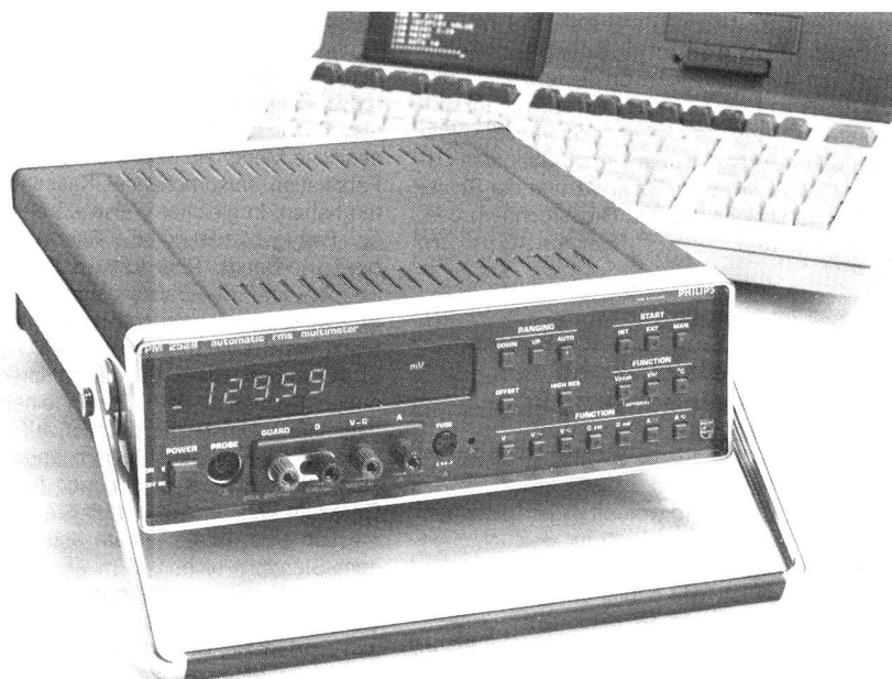
Das systemorientierte Labormultimeter von Philips misst Spannung, Strom, Widerstand sowie (mit Zubehör) Temperatur und lässt zudem Vergleichsmessungen zu.
