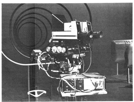
La transmission en relief n'est possible qu'avec l'utilisation de deux caméras. C'est Philips qui a mis au point le matériel pour cette expérience (Photo NDR).
