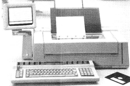
Die Textstation T 4200 von Siemens-Albis AG besteht aus dem Typenraddrucker und Elektronik in einem Tischgehäuse sowie angefügtem Bildschirm und frei beweglicher Tastatur.
