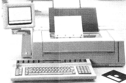
Die Textstation T 4200 von Siemens-Albis AG besteht aus dem Typenradrucker und Elektronik in einem Tischgehäuse sowie angefügtem Bildschirm und frei beweglicher Tastatur.
