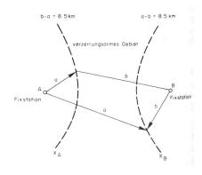
Bild 1: Zwischen den beiden Hyperbelsegmenten ist ein verzerrungsarmer Betrieb möglich weil die Laufzeitdifferenzen 30 µsek nicht übersteigen.
