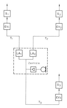
Bild 6: Gleichwellenfunknetz mit galvanischen Zubringern.
