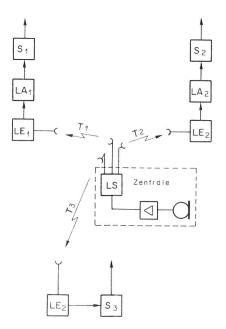
Bild 5: Gleichwellenfunknetz mit Linkzubringern
