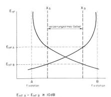
Bild 2: Ausserhalb des verzerrungsarmen Gebietes ist ebenfalls ein ungestörter Betrieb möglich, wenn das eine Signal mindestens 10 dB grösser ist als das andere.
