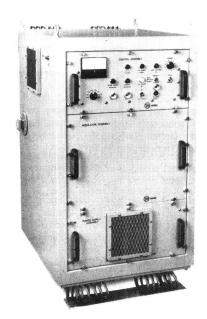
Sous-système radar, bande X
